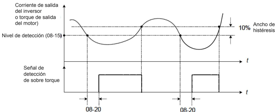
Figura 4.3.64 Operación de detección de torque bajo
