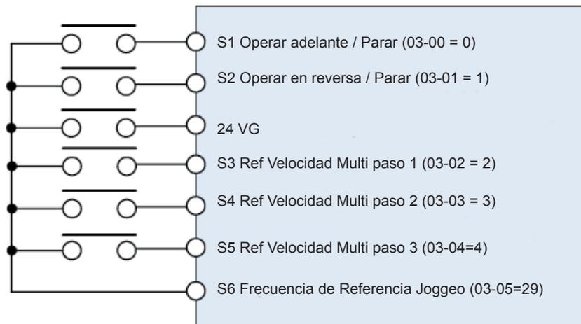
Figura 4.3.14 Ejemplo de cableado de terminal de control
