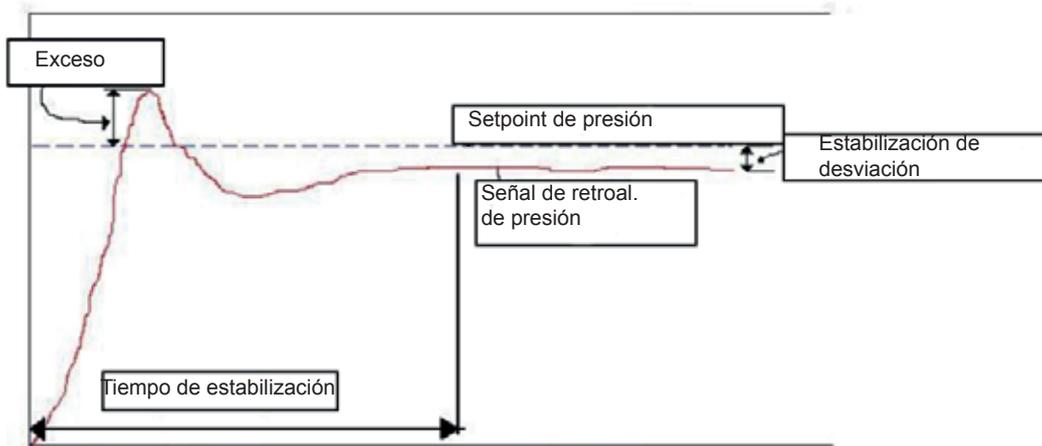
Figura 4.3.103 Respuesta de señal de retroalimentación de presión
