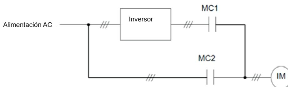
**Figura 4.3.119 Diagrama de un modo de bomba de inversor de ciclo único**
