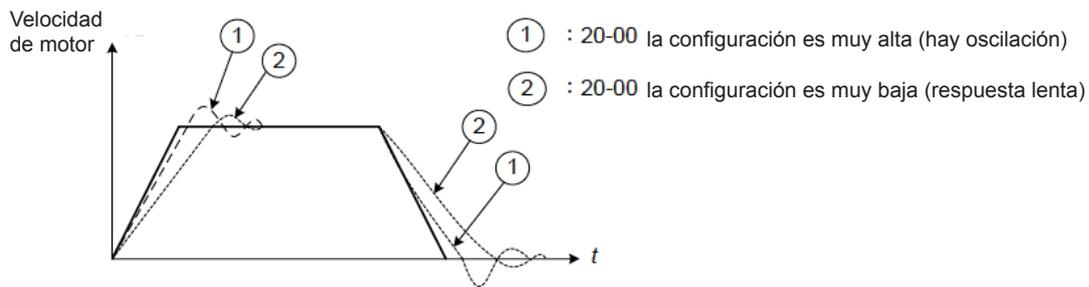
**Figura 4.3.97 Respuesta del sistema a la ganancia proporcional ASR**
