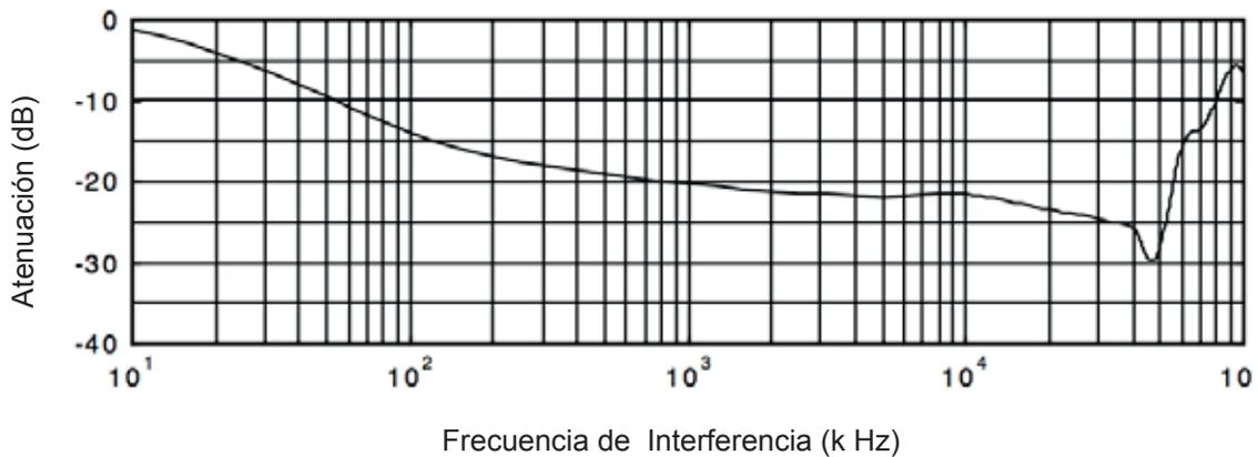
Fig. 11.4.1 Características de atenuación de frecuencia (Caja de 10 espirales)
