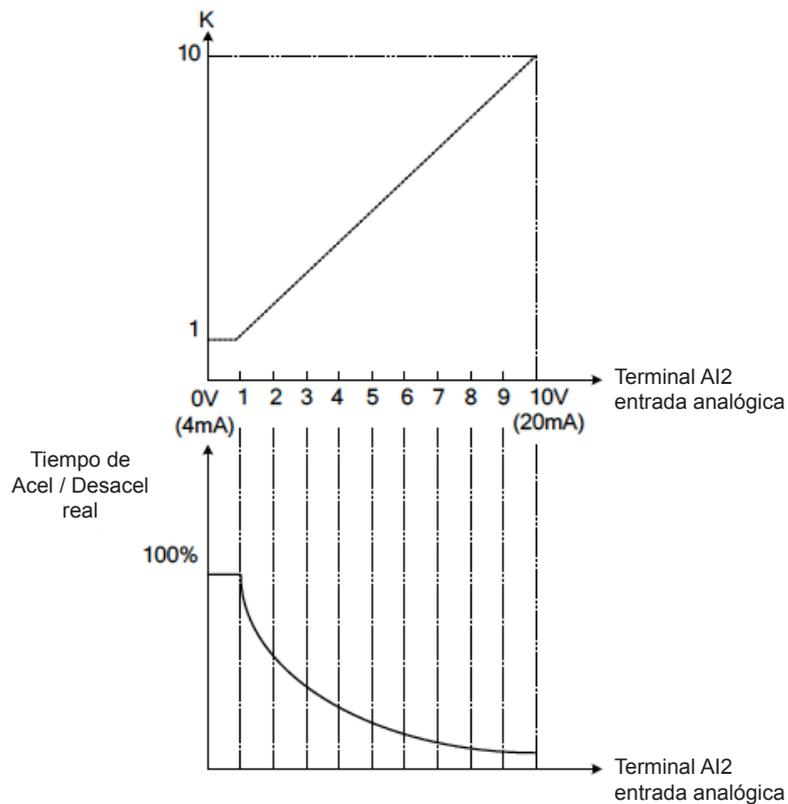
**Figura 4.3.33 Coeficiente de reducción del temporizado de aceleración y desaceleración.**
