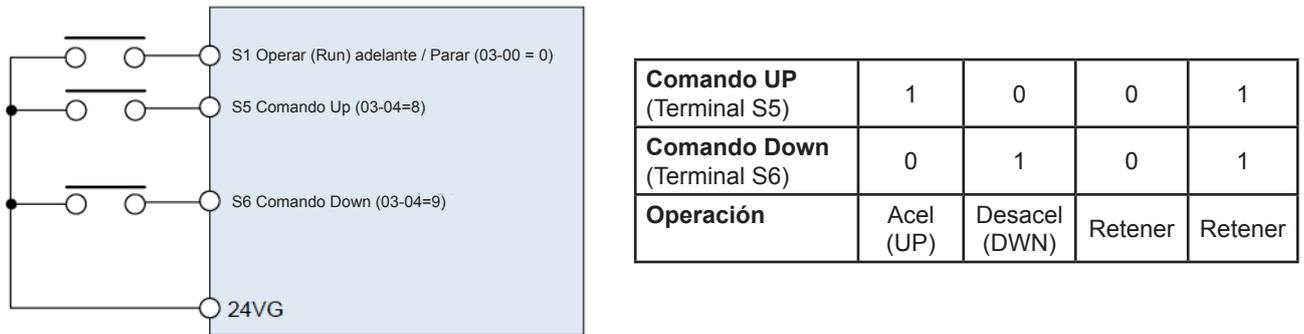
**Figura 4.3.16 Ejemplo de operación y conexiones UP/DOWN (arriba /abajo)**
