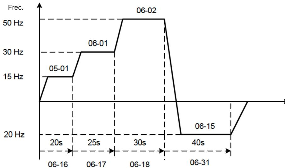
Figura 4.3.44 Operación automática de un solo ciclo (continuo)
