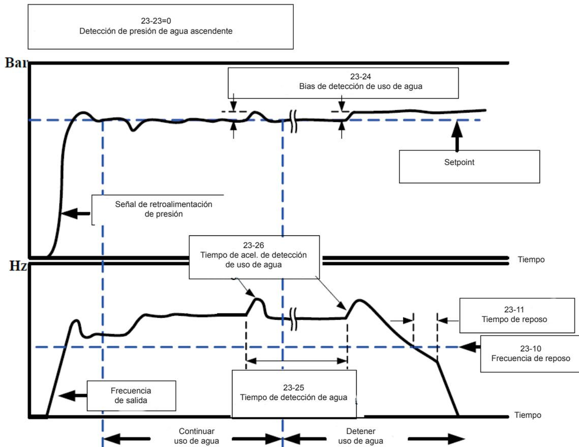
**Figura 4.3.109 Proceso de detección de presión de agua ascendente**
