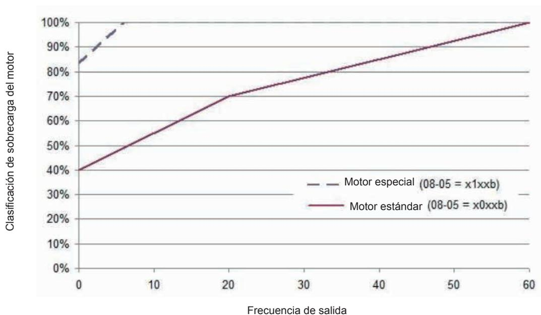
**Figura 4.3.62 Clasificación de sobrecargas del motor a diferentes frecuencias de salida.**
