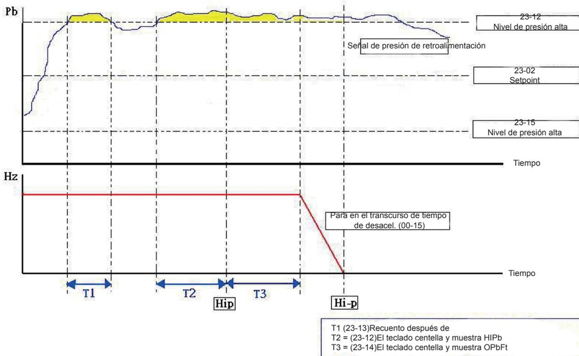
**Figura 4.3.107 Proceso de advertencia y de alarma cuando la retroalimentación es superior a 23-12**
