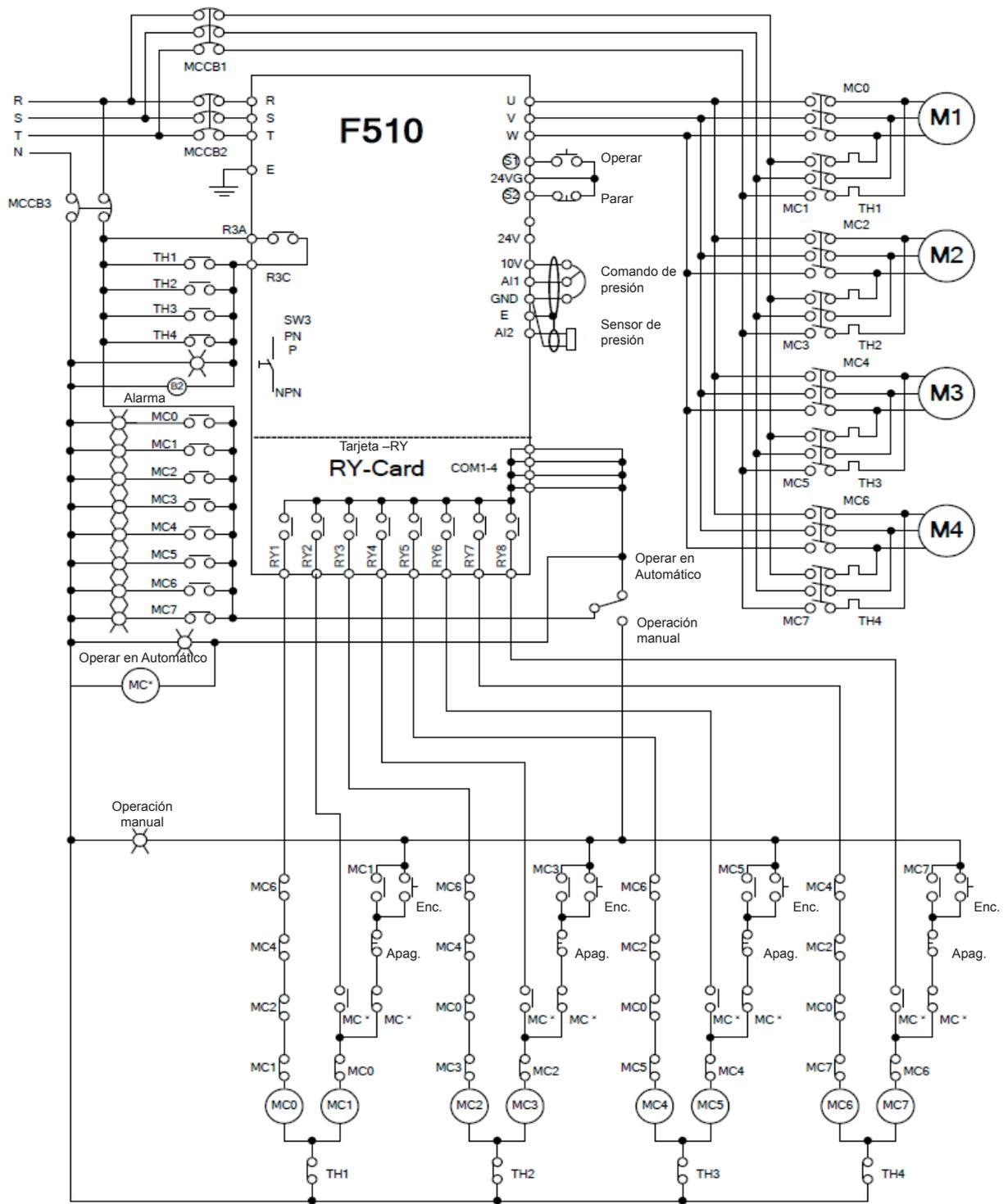
Figura 4.3.127 Cableado de bomba de inversor en modo de ciclo usando la tarjeta opcional 1 a 8
