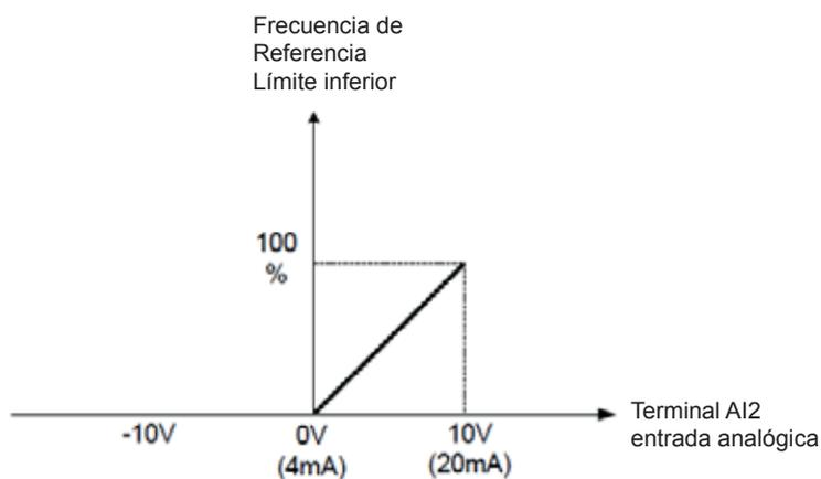
**Figura 4.3.37 Ajuste del límite inferior de frecuencia de referencia**
