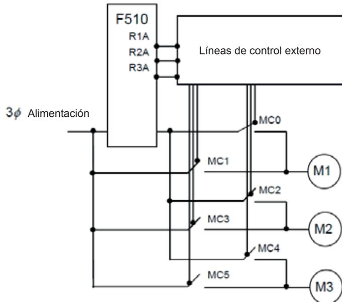
Figura 4.3.118 Modos de ciclo de bomba del inversor por medio del relé integrado
