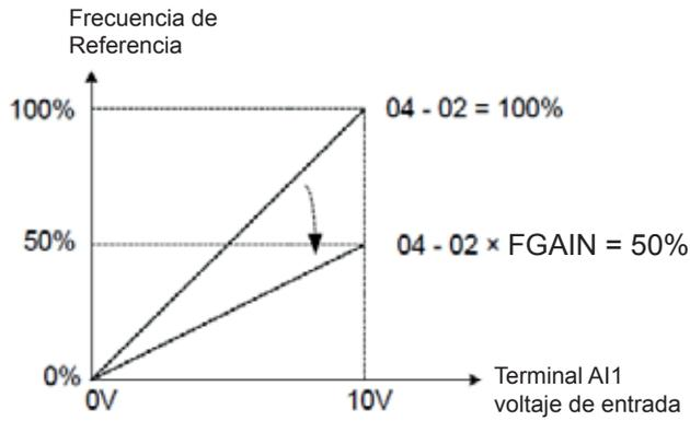
Figura 4.3.29 Ajuste de ganancia de frecuencia (ejemplo)
