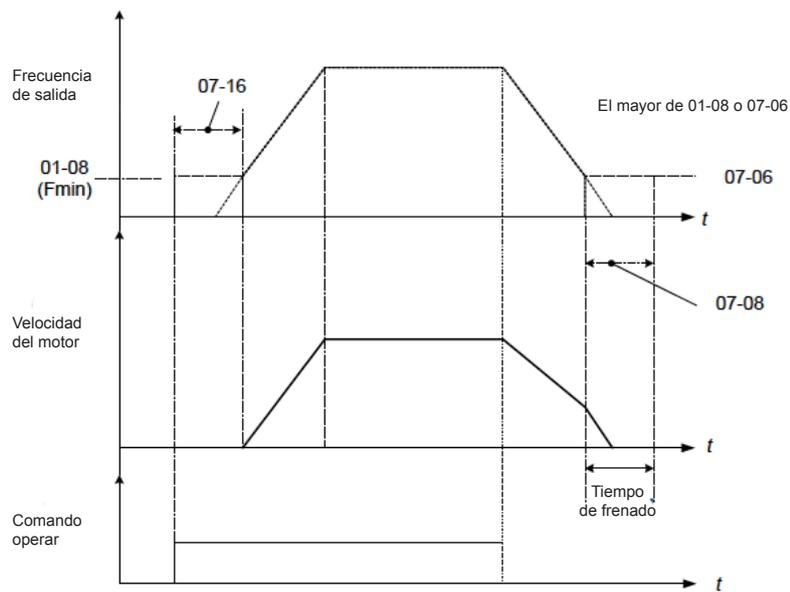
**Figura 4.3.47 Operación de frenado DC**
