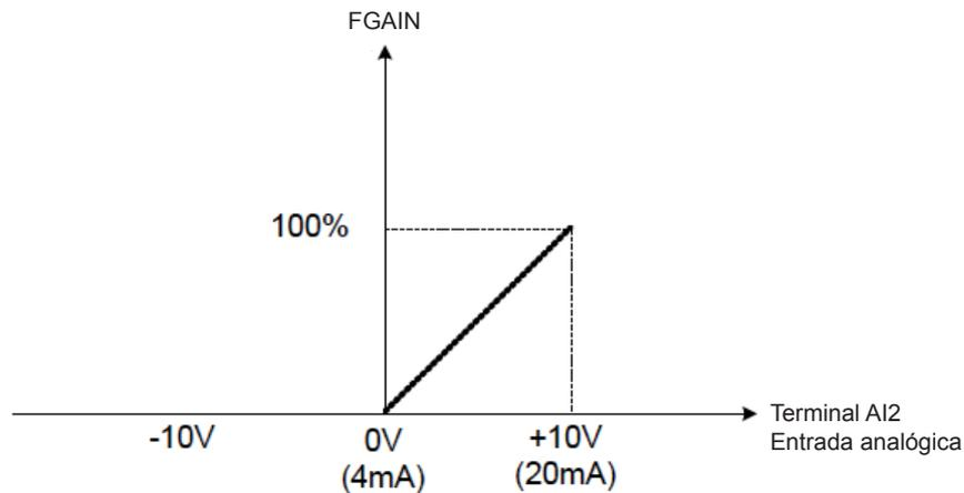
Figura 4.3.28 Ajuste de ganancia de frecuencia
