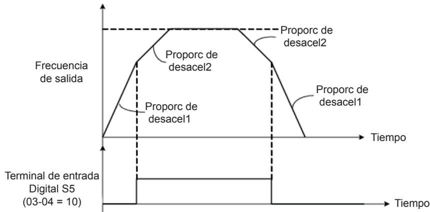
**Figura 4.3.6: Interruptor de la terminal S5 entre Taccel1/Taccel2 y Tdesac1/Tdesac2**
