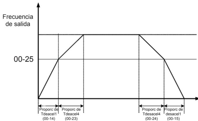
**Figura 4.3.7 Tiempo de aceleración / desaceleración de cambio automático en base a frecuencia de salida**
