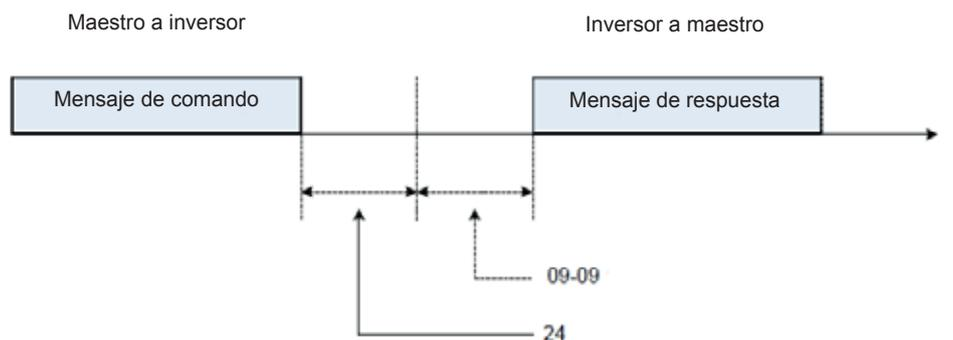
**Figura 4.3.67** Temporizado del mensaje de comunicación
