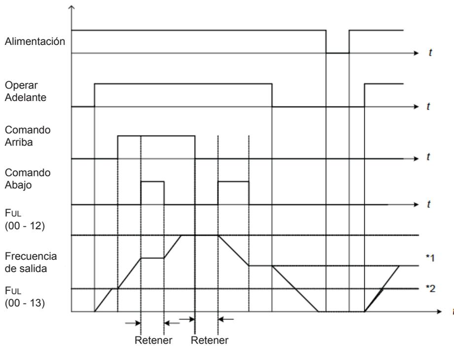
**Figura 4.3.17 Diagrama de temporizado de comando Up / Down**
