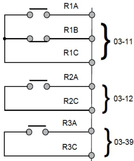
**Figura 4.3.65 Terminal de salida digital multifunción para la detección de sobre torque /torque bajo**
