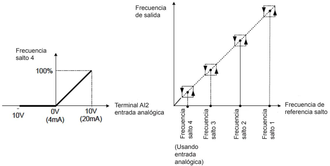
Figura 4.3.38 Configuración de operación de frecuencia salto 4
