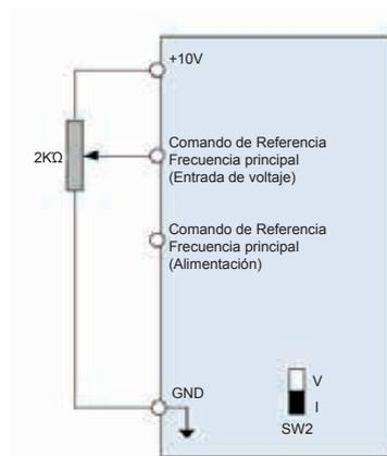
**Figura 4.3.4 Entrada analógica como comando de frecuencia referencia principal**
