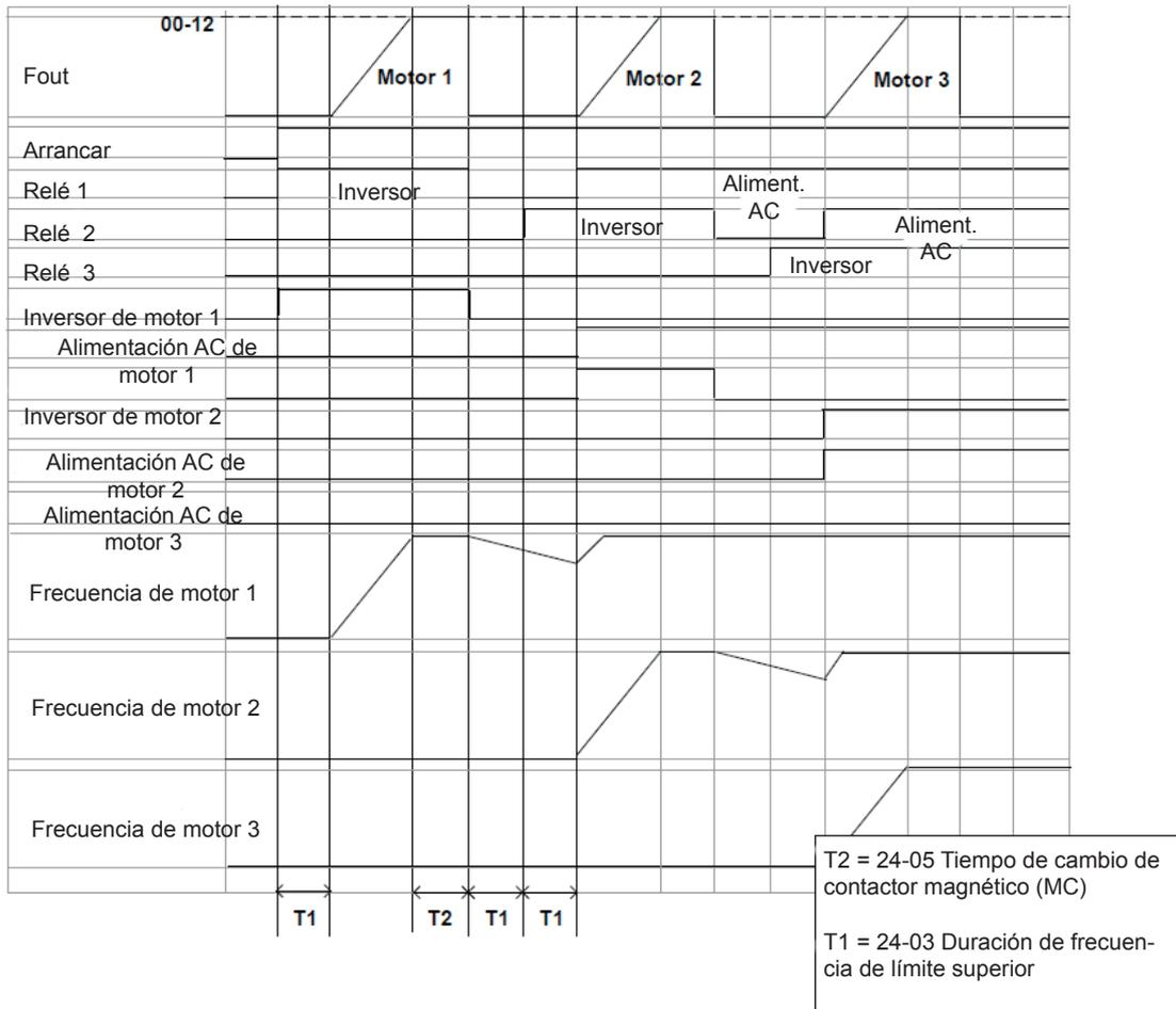
**Figura 4.3.124 Gráfica de cronometrado del encendido/apagado de relés usando relés integrados**
