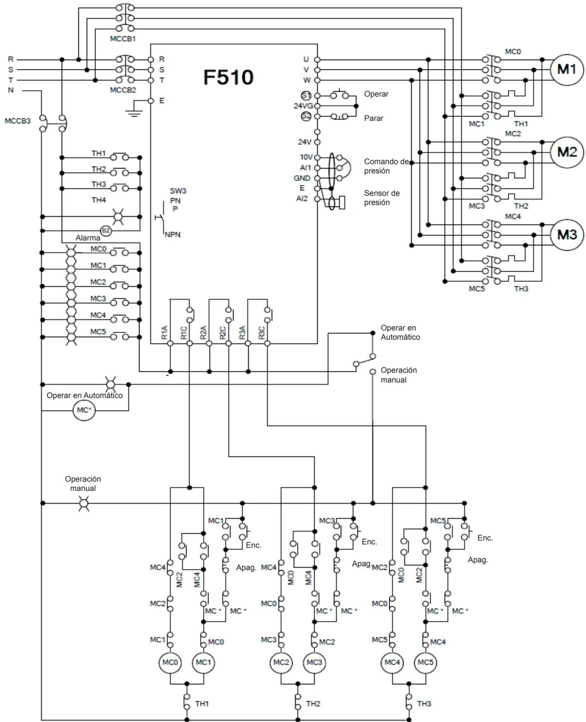
Figura 4.3.128: Cableado de bomba de inversor en modo de ciclo usando relés en la tarjeta de control
