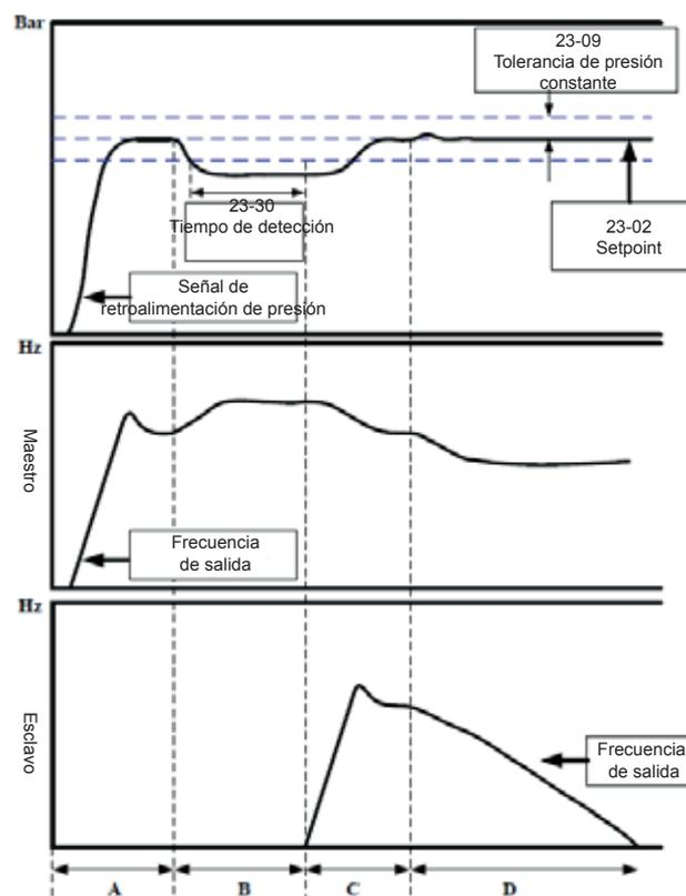
**Figura 4.3.111 Proceso de arranque de bombas duales**
