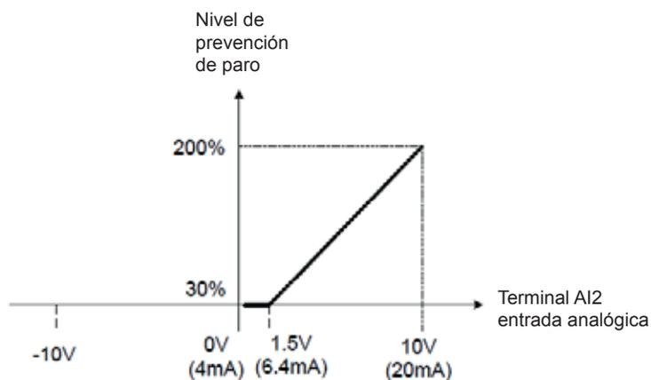
**Figura 4.3.36 Ajuste del nivel de prevención de paro durante la operación**
