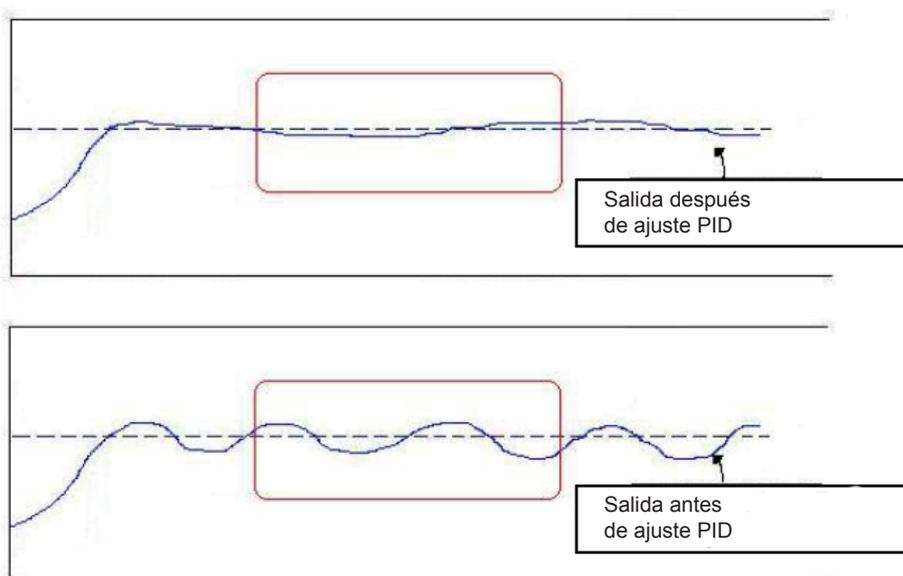
Figura 4.3.104 Respuesta de señal de retroalimentación antes/después de ajuste PID
