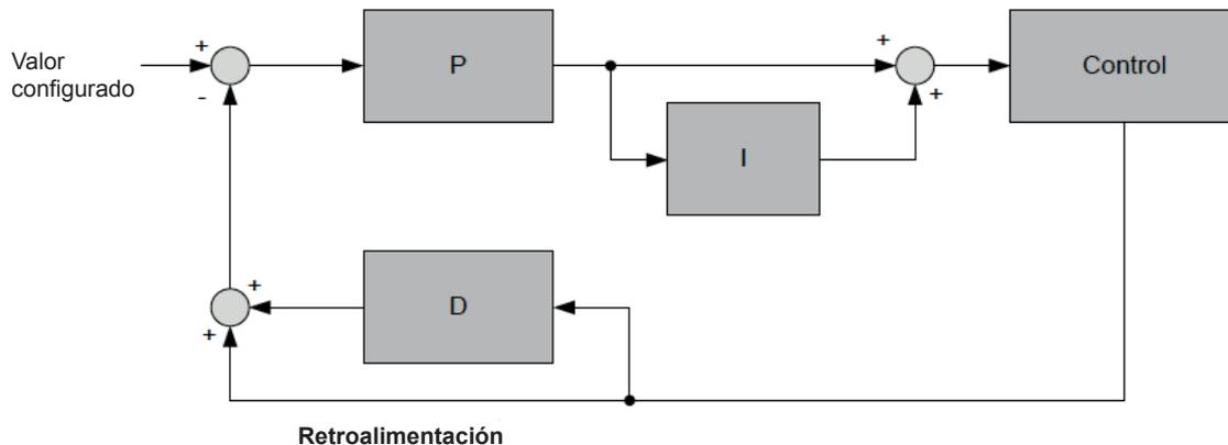
Figura 4.3.69 Control PID para valor diferencial de retroalimentación
