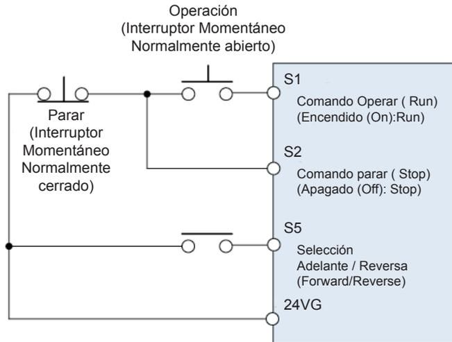
**Figura 4.3.2 Ejemplo de cableado de 3-hilos**
