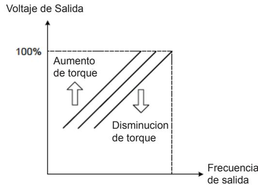
**Figura 4.3.11 Ganancia de compensación de torque para incrementar/disminuir el torque de salida**
