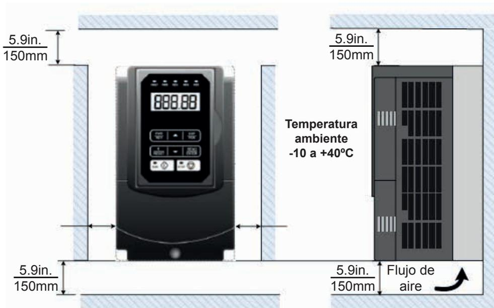
**Fig. 3.2.1: Espacio para la instalación del F510**
