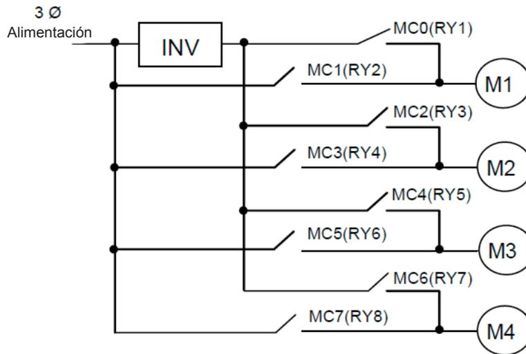
Figura 4.3.117 Modos de ciclo de bomba del inversor
