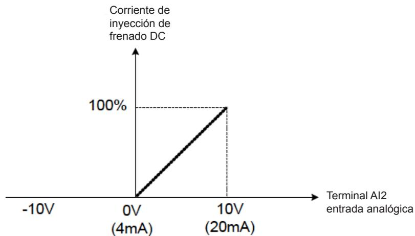
Figura 4.3.34 Ajuste de corriente de frenado DC
