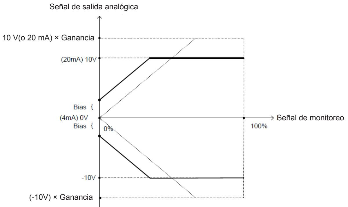
**Ajuste del nivel de salida analógica**
