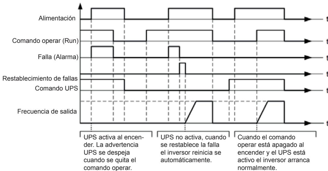
**Figura 4.3.21a** Protección de arranque desatendido
