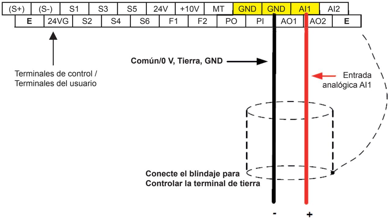
**Referencia analógica: Potenciómetro / Potenciómetro de velocidad (Configuración 00-05 = 1)**
