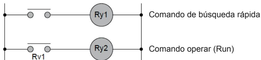
**Figura 4.3.54 Comandos de operación y de búsqueda de velocidad**
