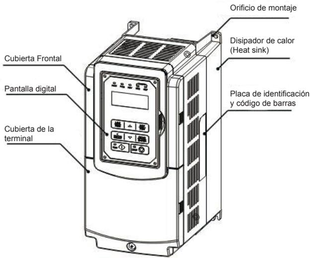
(Tipo montaje a muro, IEP IP00)
