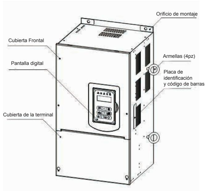
**(Tipo montaje a muro, IEC IP20, NEMA 1)**
