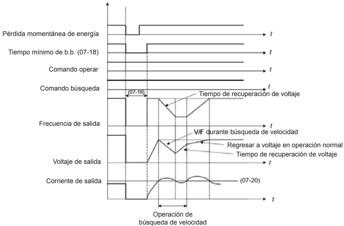
**Figura 4.3.56 búsqueda de velocidad en periodo de recuperación de una falla momentánea de energía**
