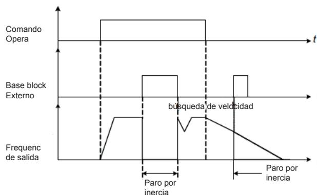
Figura 4.3.19 Operación de base block externo
