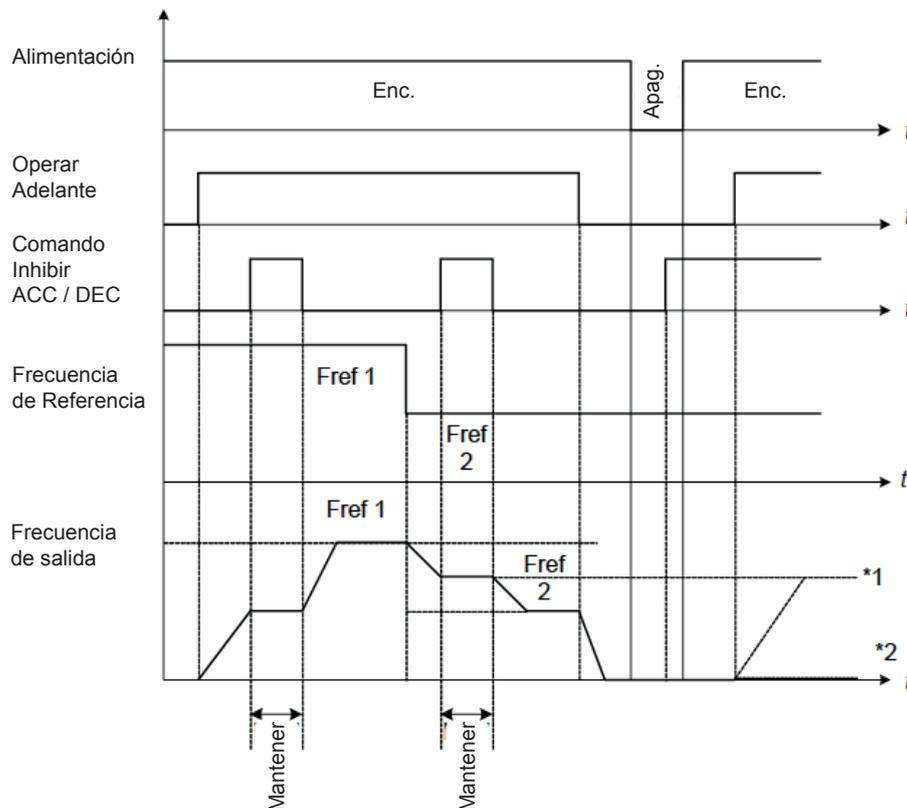
**Figura 4.3.18 Comando inhibir operación aceleración / desaceleración**
