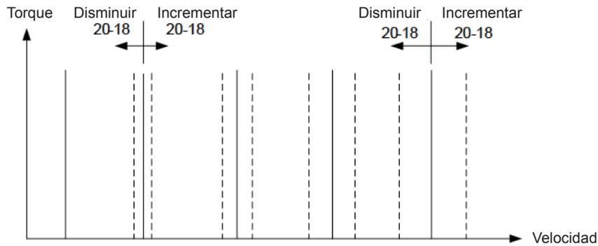
**Figura 4.3.100 Efecto la curva de velocidad de torque de 20-18**
