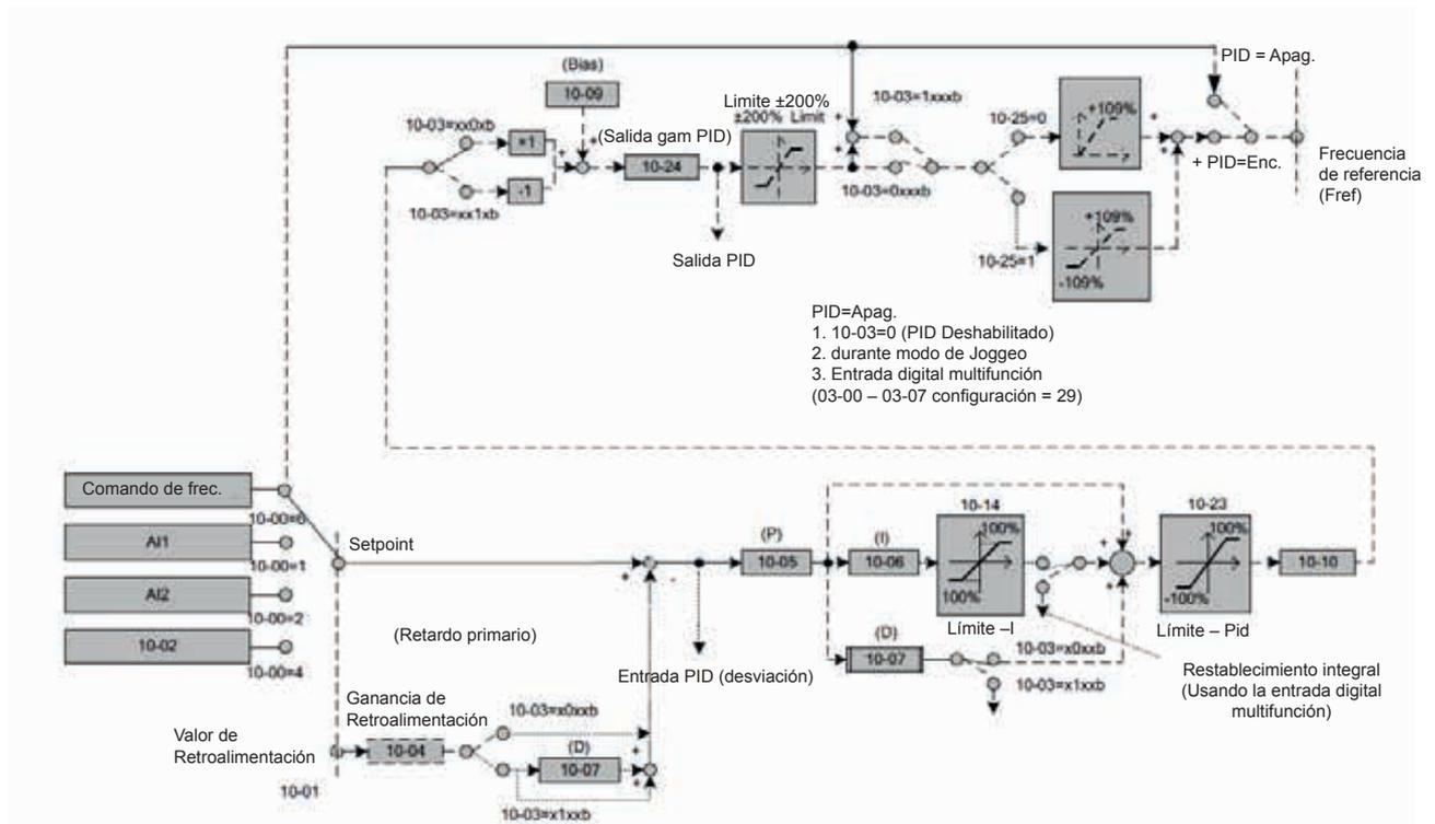
Figura 4.3.72 Diagrama del block de control PID
