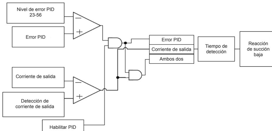
**Figura 4.3.115 Block de función de protección de succión baja**
