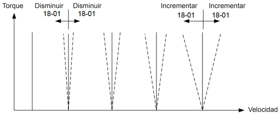
**Figura 4.3.94 18-01 Efecto en curva de velocidad de torque**
