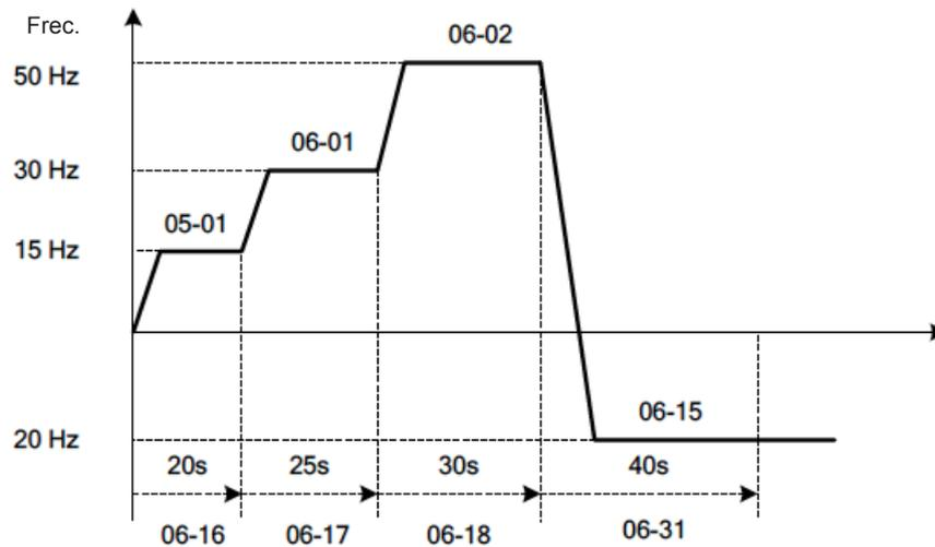
Figura 4.3.42 Operación automática de un solo ciclo (parar)
