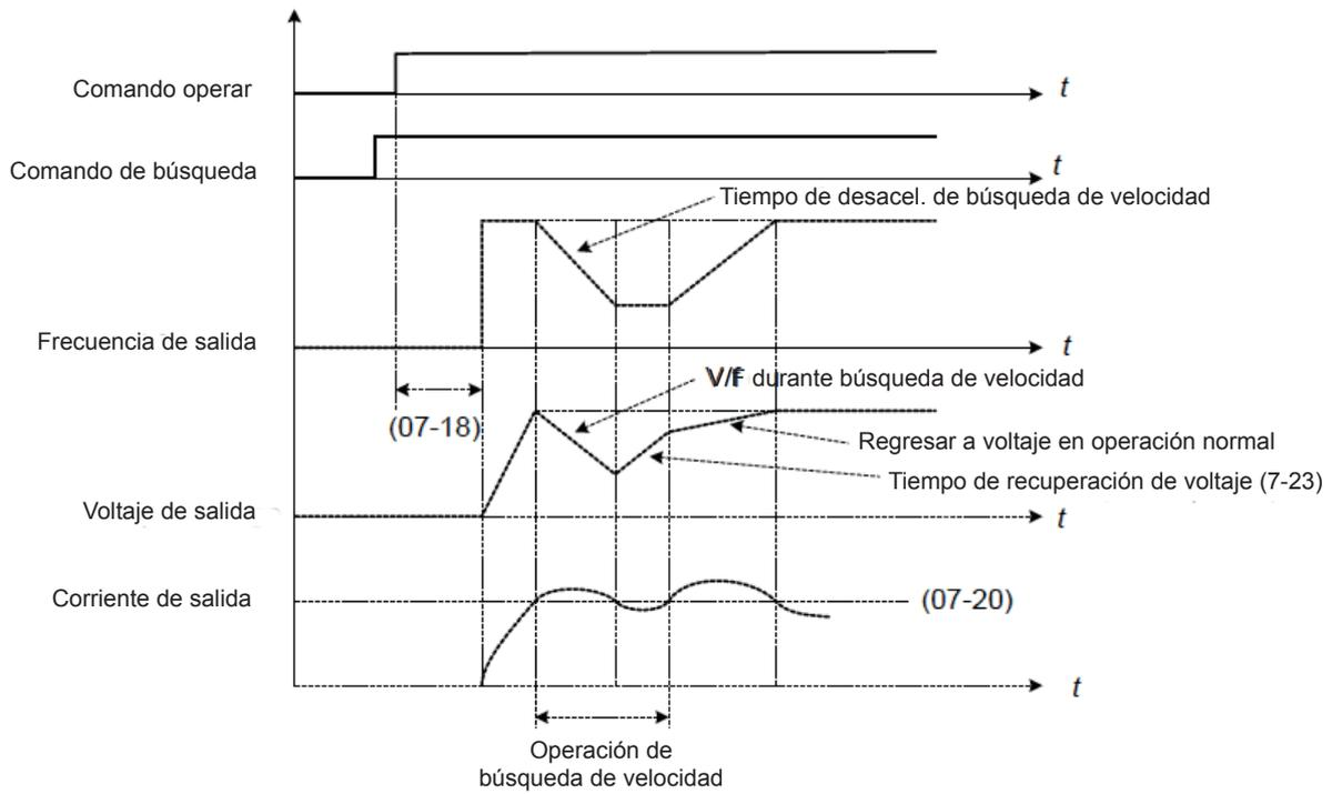
**Figura 4.3.55 Búsqueda de velocidad en el arranque**
