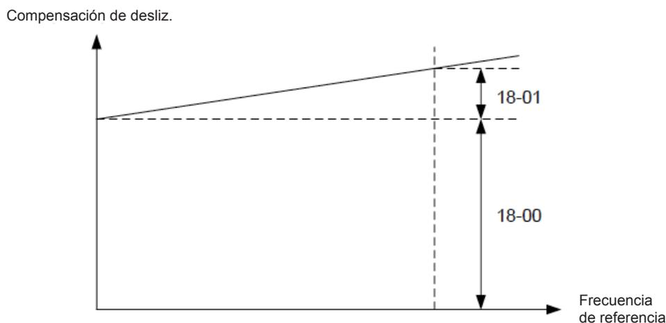
Figura 4.3.93 18-00/18-01 Ganancia de compensación de desliz. versus frecuencia de refer.
