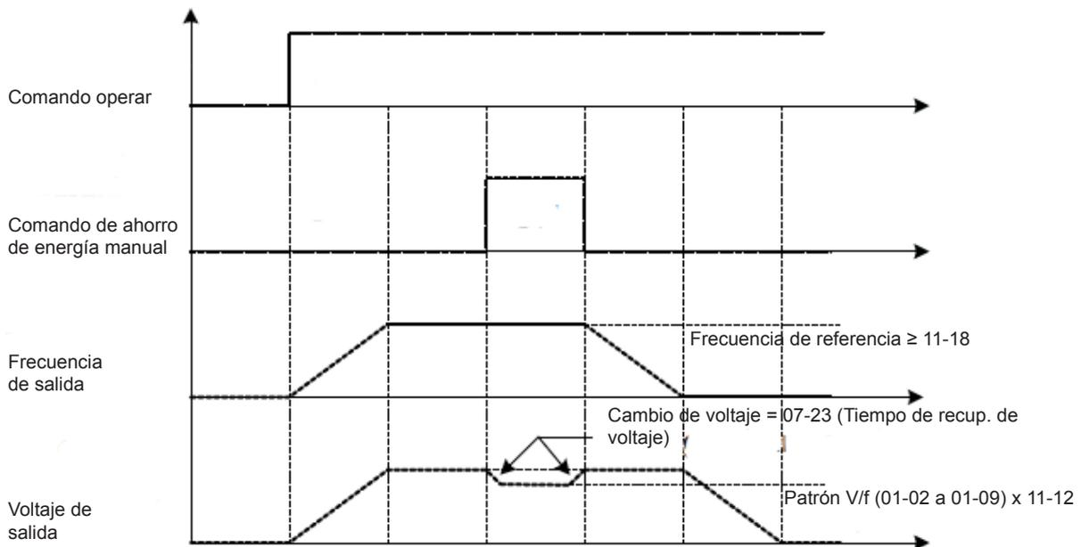
**Figura 4.3.79 Operación de ahorro manual de energía**
