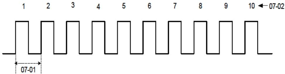
**Figura 4.3.45 Operación de reinicio automático**
