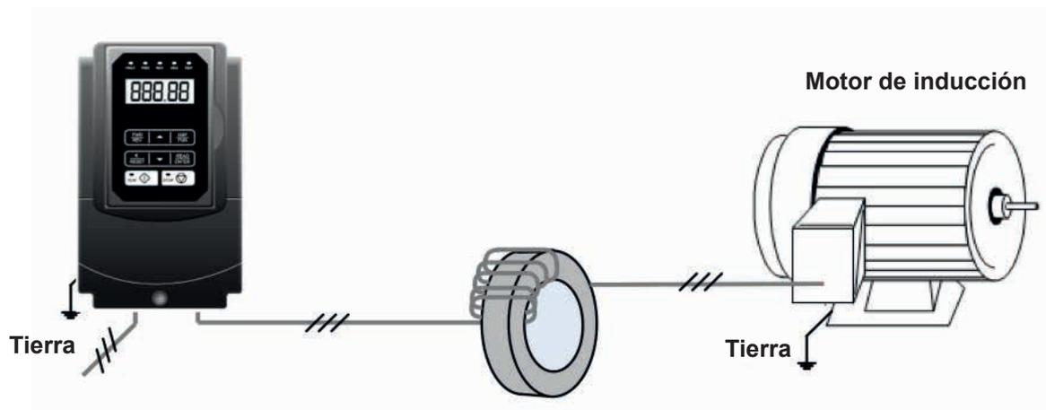
Fig. 11.4.2 Ejemplo de aplicación con núcleo de supresión de fase cero EMI
