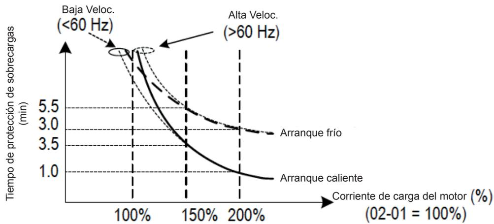
**Figura 4.3.61 Curva de protección contra sobrecargas del motor. (ejemplo: motor estándar)**
