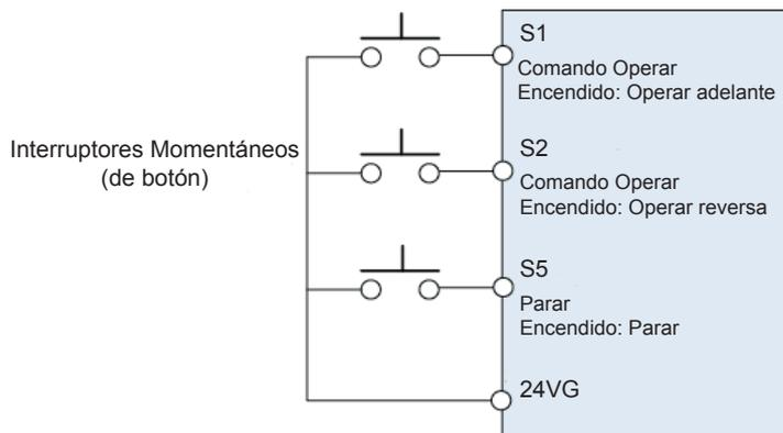
**Nota:** Las terminales S1, S2 y S5 deben estar cerradas por un mínimo de 50 ms para activar la operación. El inversor mostrará el error SE2 cuando las terminales S1-S6 sean configuradas a 53 y 26 simultáneamente.
