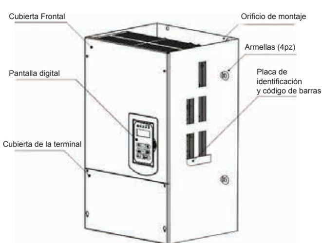
**(Tipo montaje a muro, IEC IP00)**
