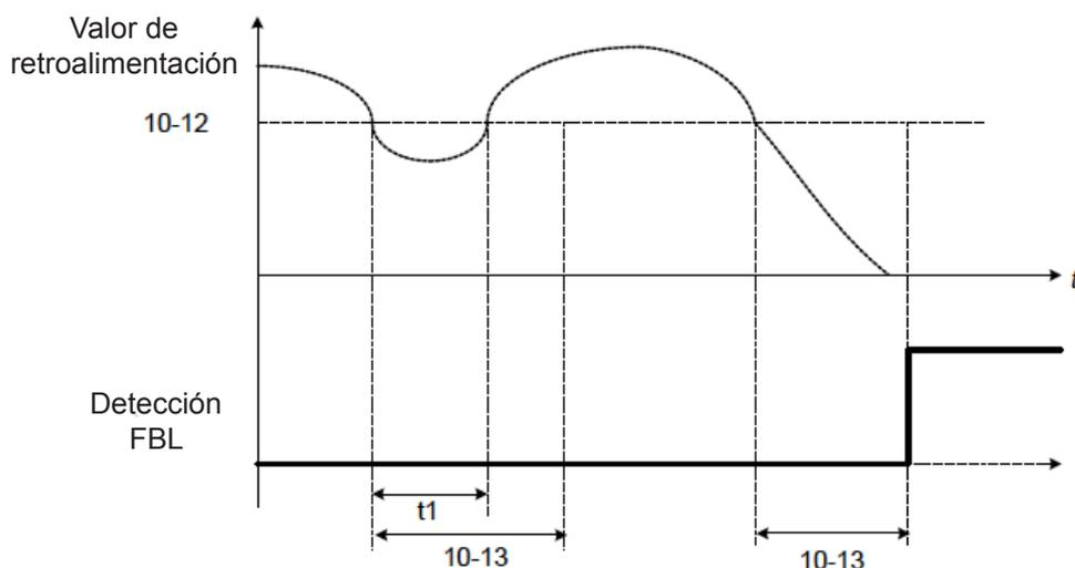
**Figura 4.3.73 Detección de pérdida de retroalimentación PID**
