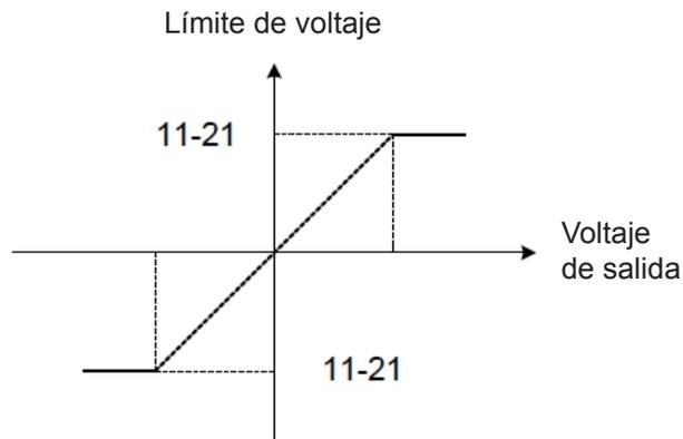
**Figura 4.3.80 Valor del límite de voltaje en la operación de comisionado**
