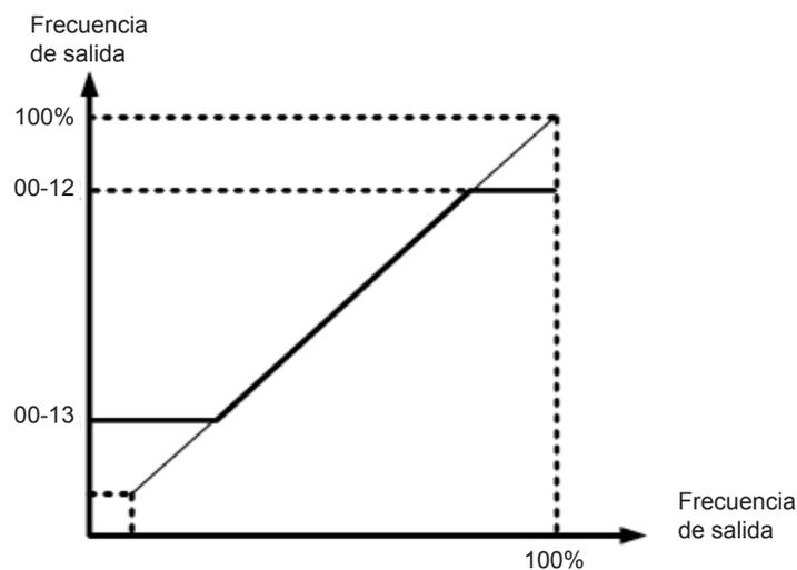
**Figura 4.3.5 Límites superior e inferior de frecuencia de referencia**
