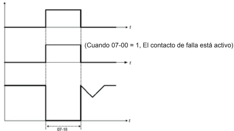
**Figura 4.3.46 Operación de reinicio automático**
