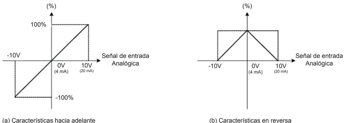
**Figura 4.3.9 Entrada analógica positiva/negativa como comando de frecuencia de referencia principal.**
