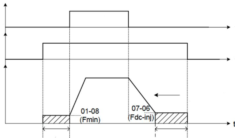
**Figura 4.3.21 Diagrama de temporizado de frenado**
