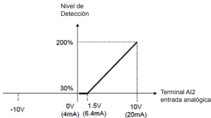
Figura 4.3.35 Ajuste del nivel de detección de sobre torque/menos torque
