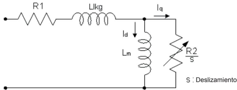
**Figura 4.3.12-b Modelo equivalente de un motor de inducción Y-**
