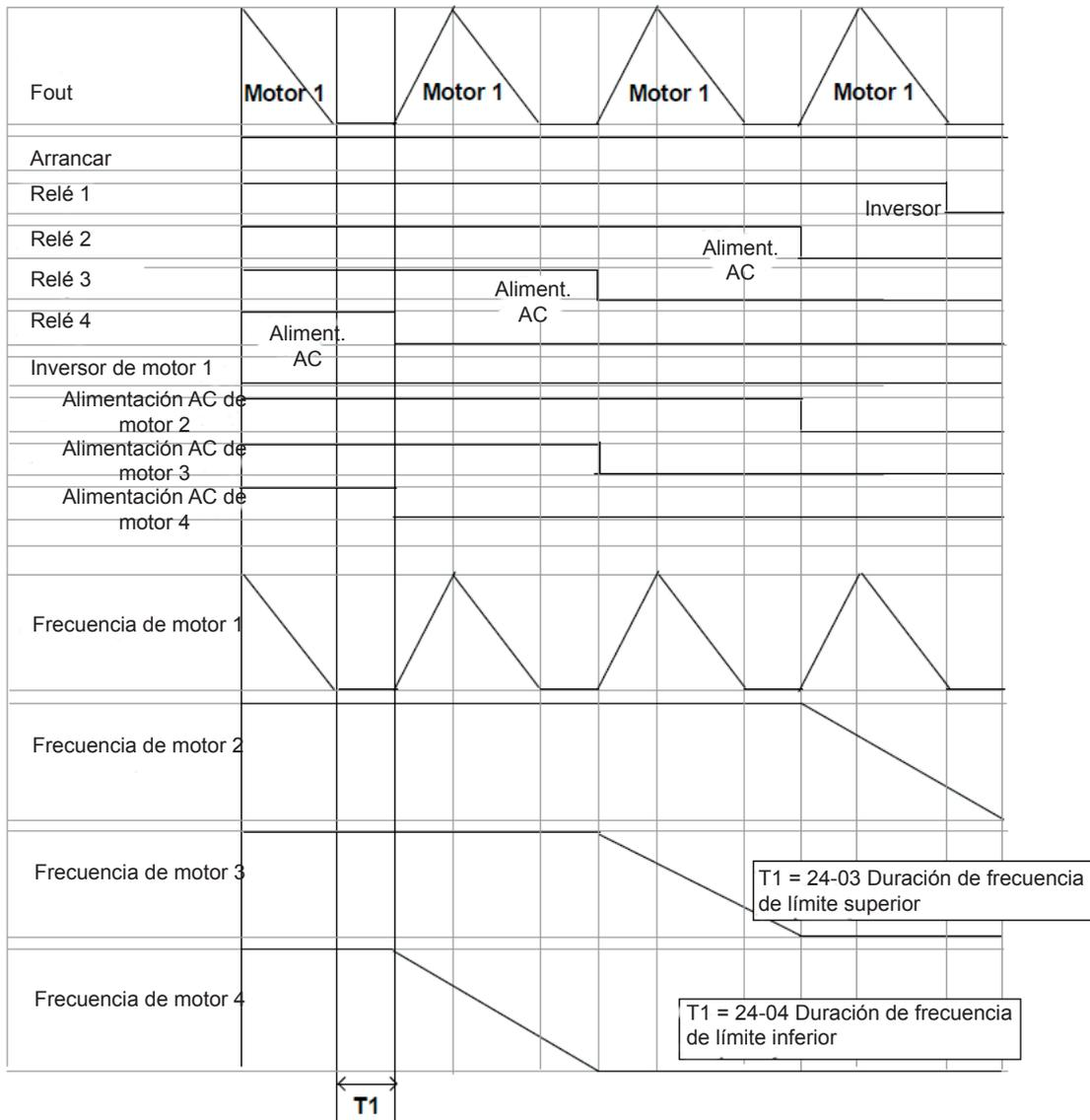
**Figura 4.3.121 Gráfica de cronometrado del apagado de relés en modo fijo**
