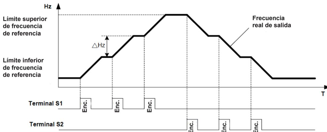
Modo 3: Cuando 03-40 es mayor a 0 Hz y la terminal de entrada está activa por más de 2 seg, la frecuencia se elevará usando los tiempos de aceleración/ desaceleración.
