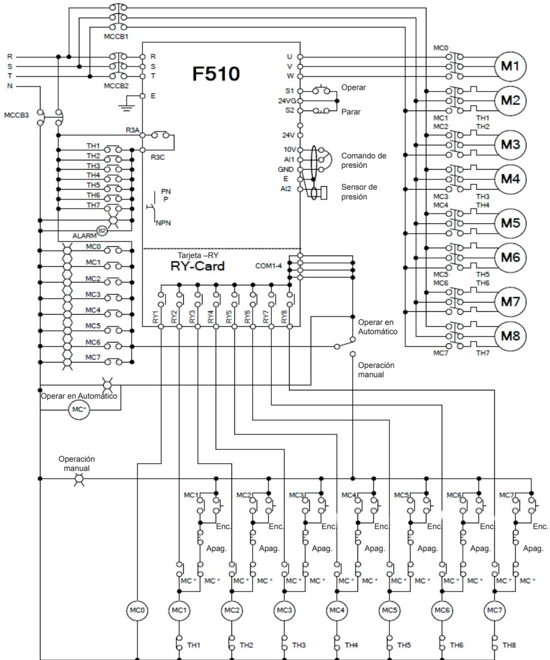
Figura 4.3.126 Cableado de bomba de inversor en modo fijo usando la tarjeta opcional 1 a 8
