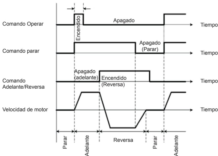
**Figura 4.3.3 Operación de 3-hilos**
