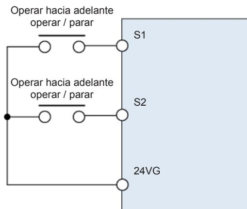
Figura 4.3.1 Ejemplo de cableado de 2-hilos
