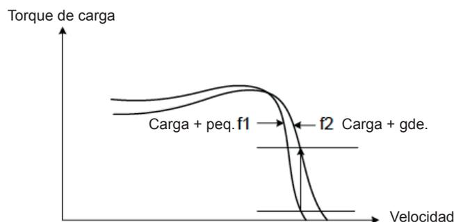
**Figura 4.3.90 Frecuencia de salida de la compensación de deslizamiento**
