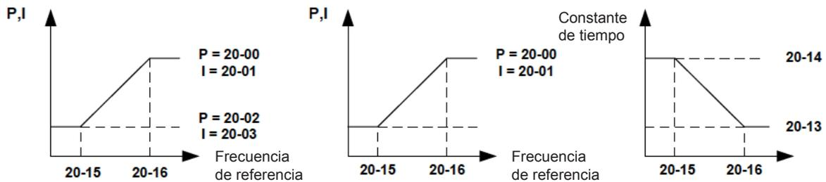
**Figura 4.3.96 Configuración de ganancia ASR (modo SLV)**
