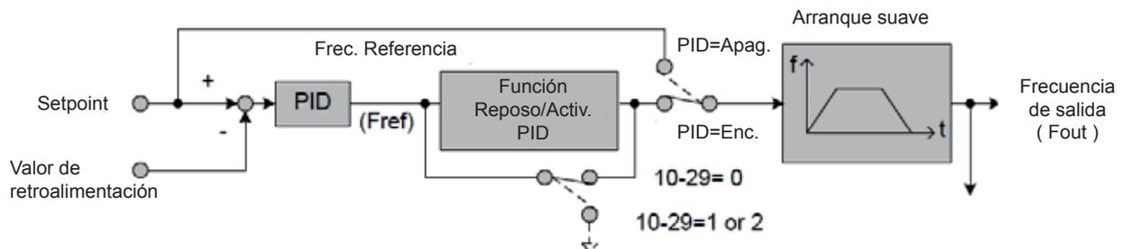
**Figura 4.3.74: (a) Diagrama del block de control PID**
