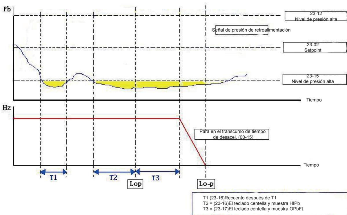
Figura 4.3.108 Proceso de advertencia y de alarma cuando la retroalimentación es inferior a 23-15.
