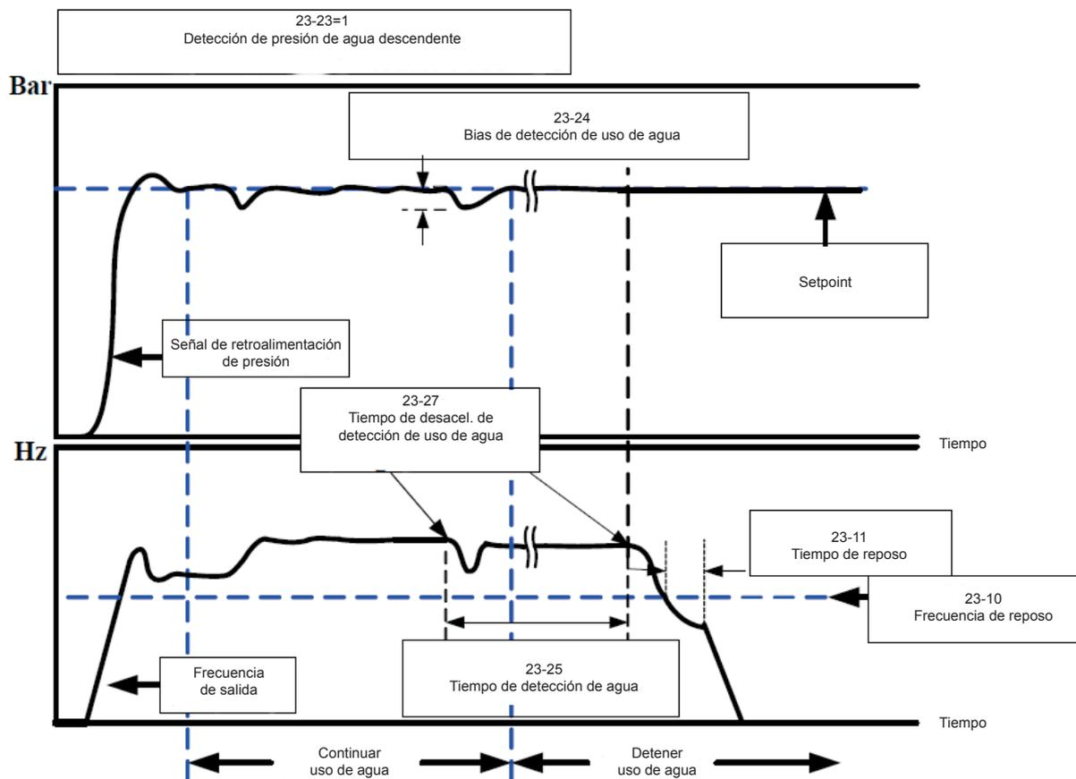
**Figura 4.3.110 Proceso de detección de presión de agua descendente**
