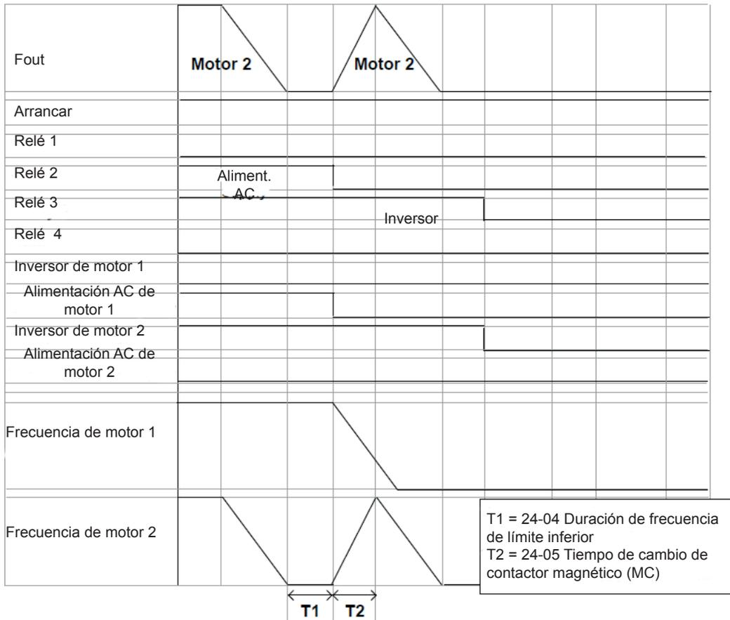
**Figura 4.3.123 Gráfica de cronometrado del apagado de relés en modo de ciclo**
