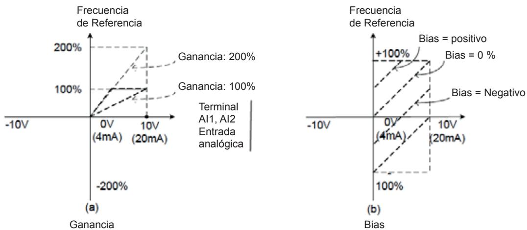
**Figura 4.3.26 Operaciones de ganancia y bias (Para señal de frecuencia de referencia)**
