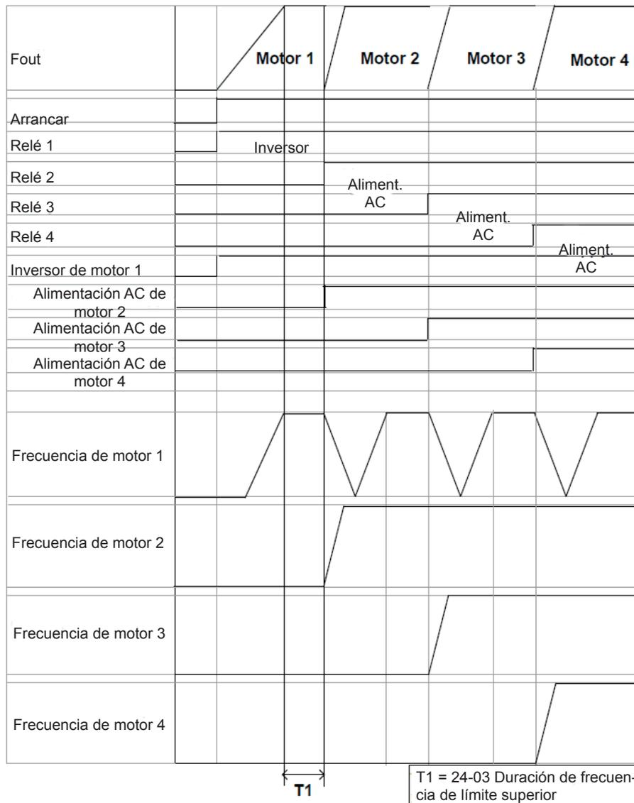
**Figura 4.3.120 Gráfica de cronometrado del encendido de relé en modo fijo**
