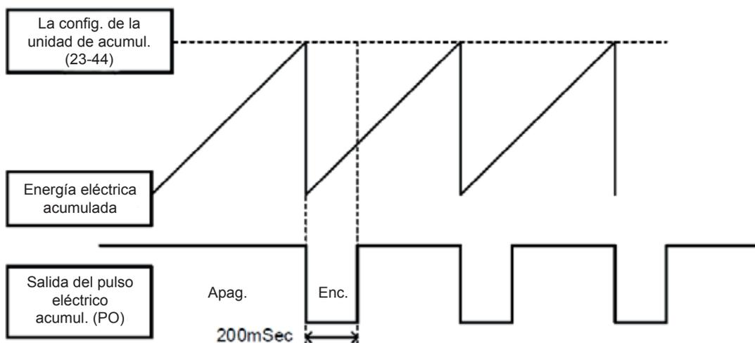
**Figura 4.3.112 Salida de pulso eléctrico acumulativo**
