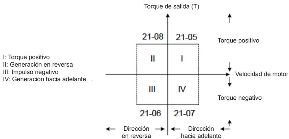
**Figura 4.3.101 Configuración del límite de torque**
