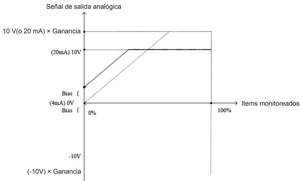
Figura 4.3.41 Ajuste del nivel de salida analógica
