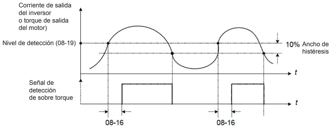
Figura 4.3.63 Operación de detección de sobre torque
