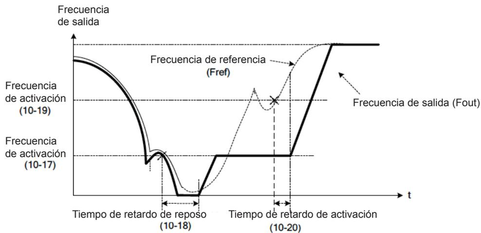
**Figura 4.3.74: (c) Diagrama de temporizado de frec. reposo / activación (sleep / wakeup) PID**
