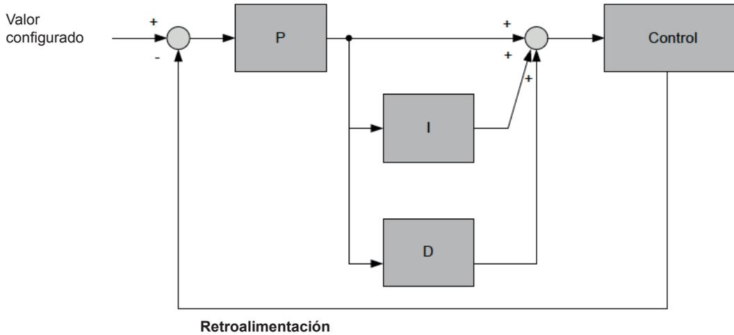
**Figura 4.3.70 Control PID para valor diferencial de retroalimentación**
