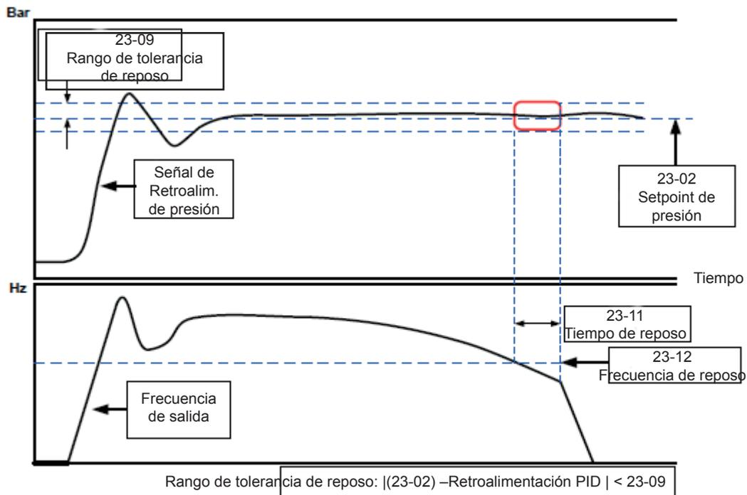
**Figura 4.3.105 Respuesta del sistema de presión constante**
