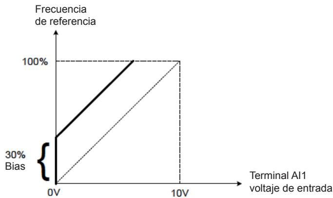
Figura 4.3.31 Ajuste bias de la frecuencia de referencia (ejemplo)
