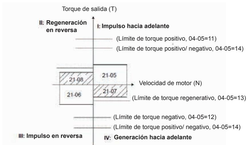
**Figura 4.3.102 Límite de torque de entrada analógica (AI2)**
