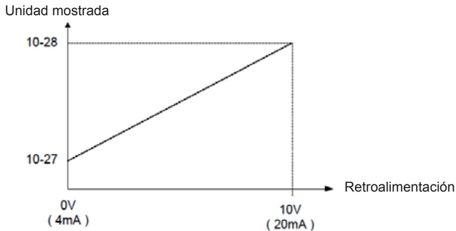
Figura 4.3.75 Escalamiento de la señal de retroalimentación
