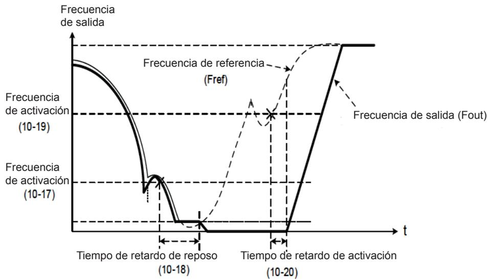
**Figura 4.3.74: Diagrama de temporizado de reposo / activación (sleep / wakeup) PID**
