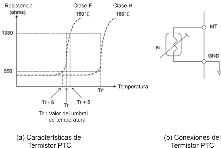
**Figura 4.3.66 Protección contra sobrecalentamiento del motor**
