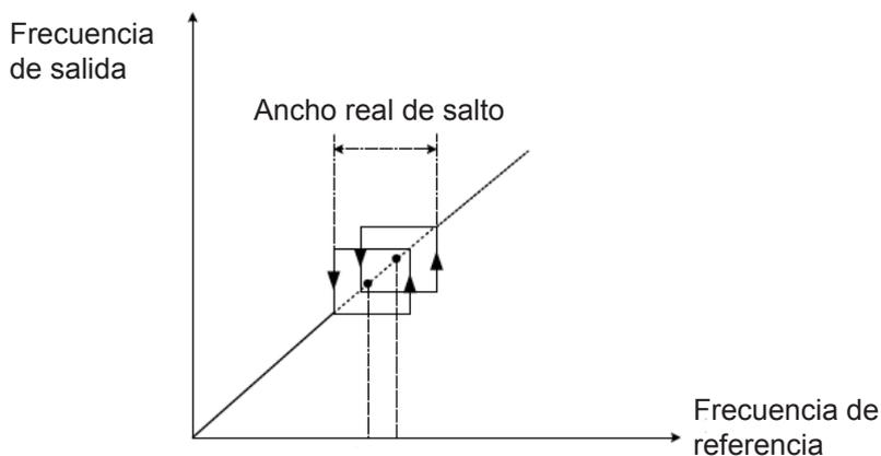
**Figura 4.3.78 Traslape de frecuencia salto**
