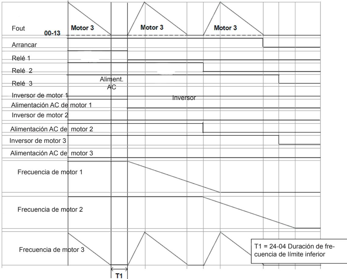
**Figura 4.3.125 Cronometrado usando relés en el tablero de control**
