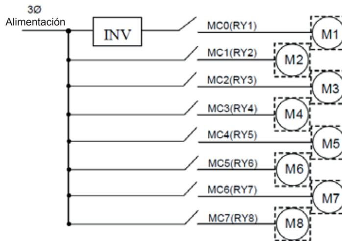
**Figura 4.3.116 Modos fijos de la bomba del inversor**
