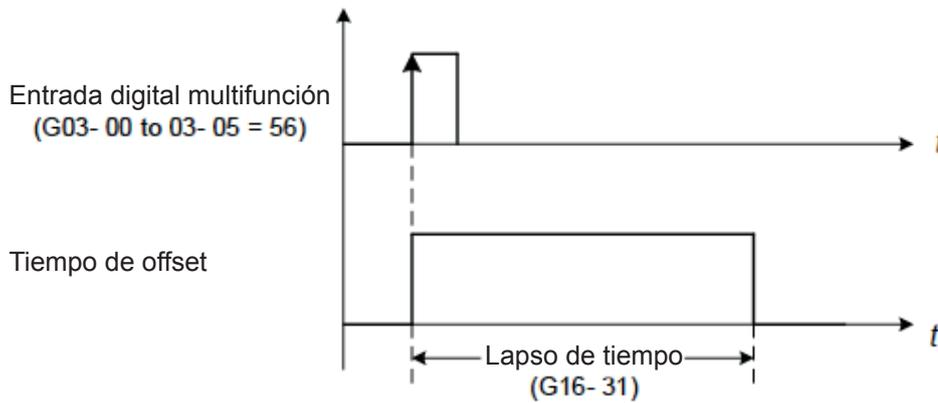
**Figura 4.3 4.3.88 Operación de tiempo de sincronización**
