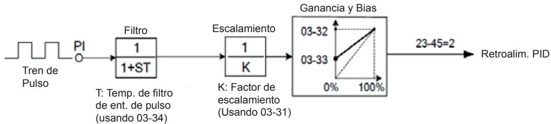
**Figura 4.3.24 Ajuste de entrada de pulso**
